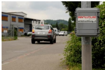
Zählgerät an Kandelaber montiert
